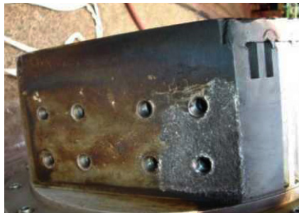
Рис. 2. Подтверждение анализов на основе СД «Дианы». Фланцы ввода, на которых показана карбонизация, плавление и коррозия материалов
