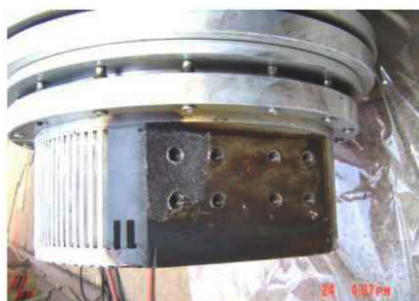
Рис. 2. Подтверждение анализов на основе СД «Дианы». Фланцы ввода, на которых показана карбонизация, плавление и коррозия материалов
